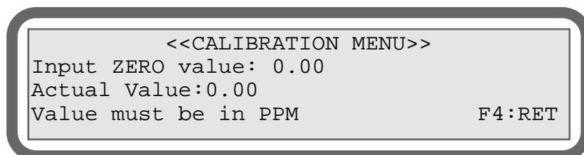
FIG 4: SETTING THE ZERO GAS VALUE
